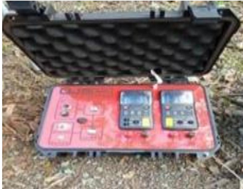
GAMBAR 2. Alat ukur *resistivitymeter*.
