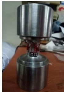
Gambar 6. Strain gauge yang terpasang pada frame load cell .
