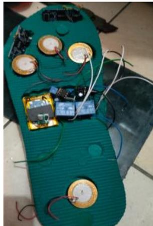
GAMBAR 5. Proses Perangkaian sistem Navigasi pada Sandal
