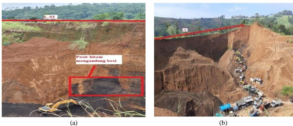
GAMBAR 3. (a) Pasir hitam dan (b) Singkapan pasir hitam lintasan 01 dan menunjukkan singkapan area tambang, pasir yang berwarna hitam merupakan pasir objek penelitian ini.
