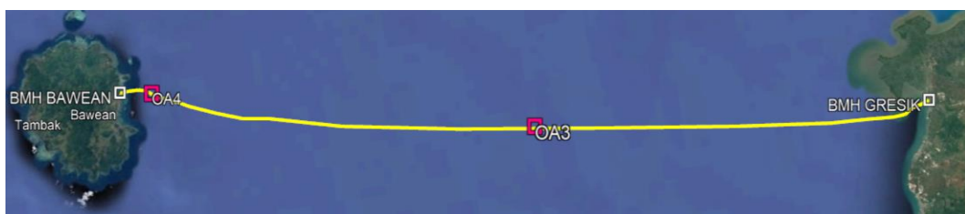
Gambar 4. Peta rute kabel dan titik optical amplifier dari BMH Gresik-BMH Bawean
