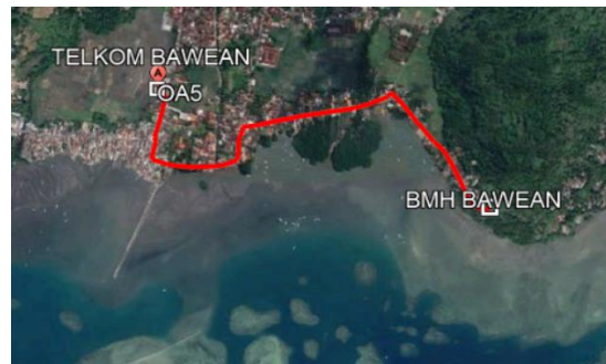
GAMBAR 5. Peta rute kabel dan titik optical amplifier dari BMH Bawean ke STO Bawean
