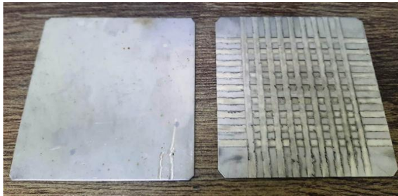
GAMBAR 2 a) Pelat elektroda polos dan b) pelat elektroda tekstur
