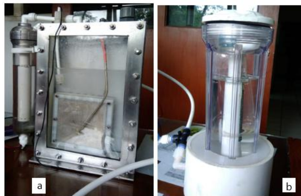
GAMBAR 3 (a) HHO generator dan (b) Flowmeter gas HHO.
