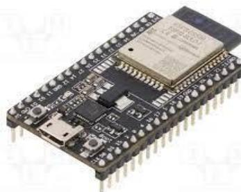
**GAMBAR 1.** Mikrokontroller ESP32.
