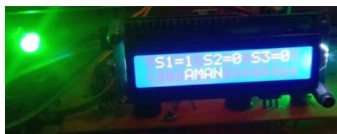
**GAMBAR 7.** Hasil pengujian sensor air pada level 1.
