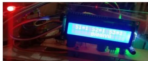
GAMBAR 9. Hasil pengujian sensor air pada level 3.
