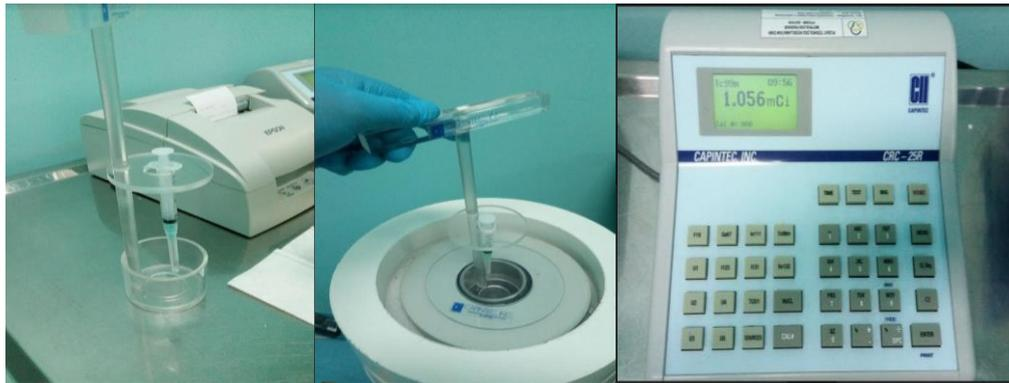
**GAMBAR 1.** Proses pengukuran dosis residu spuit menggunakan dose kalibrator (dok.pribadi)
