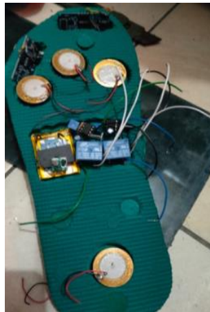
GAMBAR 5. Proses Perangkaian sistem Navigasi pada Sandal
