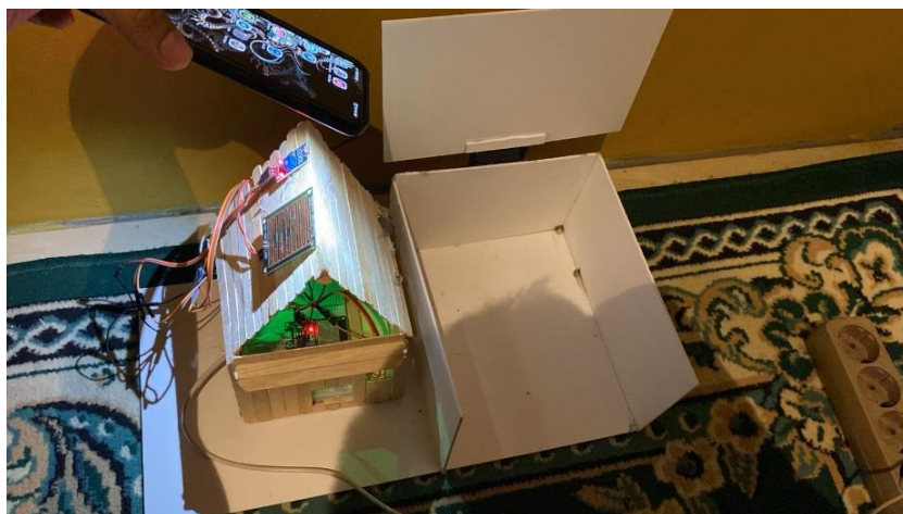
GAMBAR 6. Pengujian sensor LDR.
