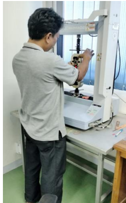
GAMBAR 5. Proses pemasangan material pada alat uji tarik.
