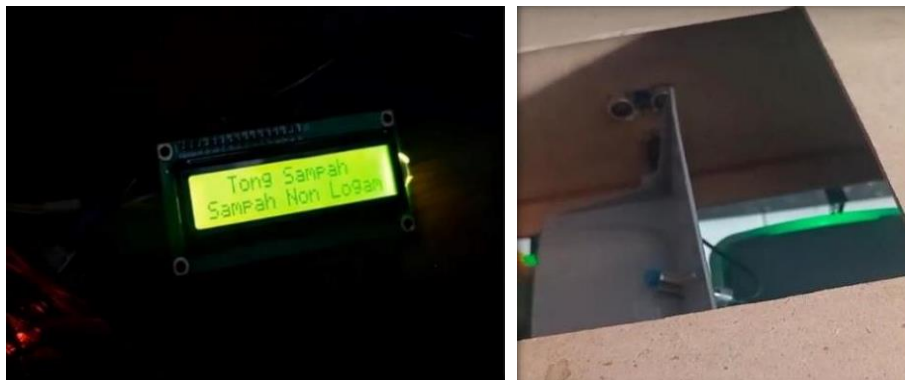
GAMBAR 7. Tampilan LCD dan posisi pemilah saat terdeteksi sampah non-logam.
