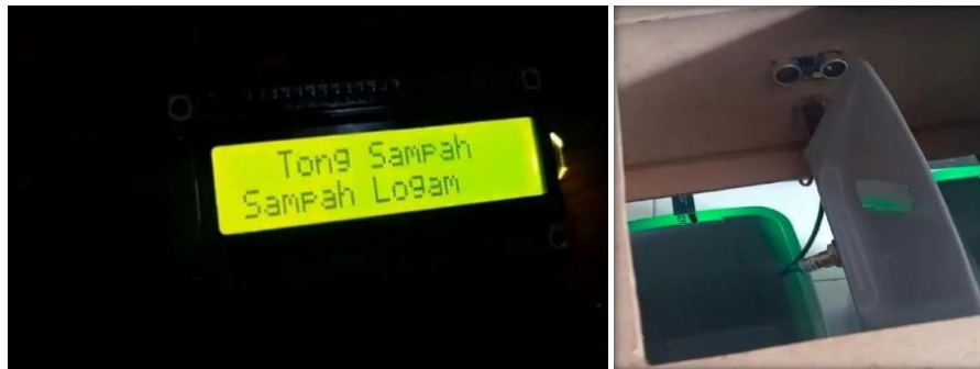
GAMBAR 6. Tampilan LCD dan posisi pemilah Saat terdeteksi sampah logam.
