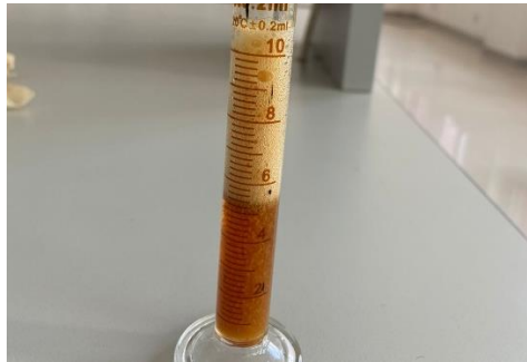
GAMBAR 3. Busa yang dihasilkan setelah pengocokan
