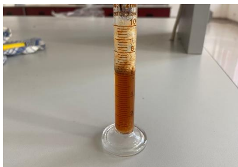
GAMBAR 4. Penurunan busa setelah didiamkan selama 15 menit.
