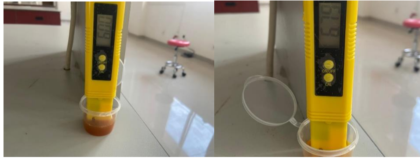
GAMBAR 5. Pengujian pH dengan pH meter.
