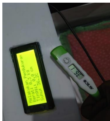
GAMBAR 8. Perbandingan pembacaan sensor DS18B20 dan termometer klinis referensi.
