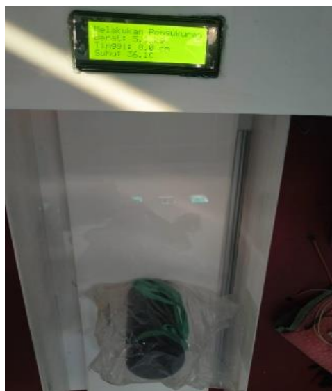
GAMBAR 5. Pengujian sensor load cell menggunakan anak timbangan terstandar.
