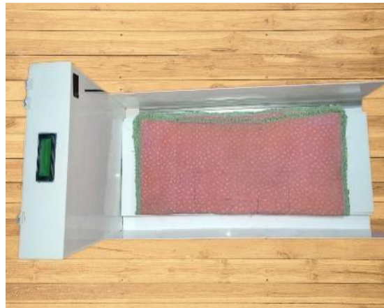
GAMBAR 4. Prototipe alat pengukur antropometri bayi (tampak atas).
