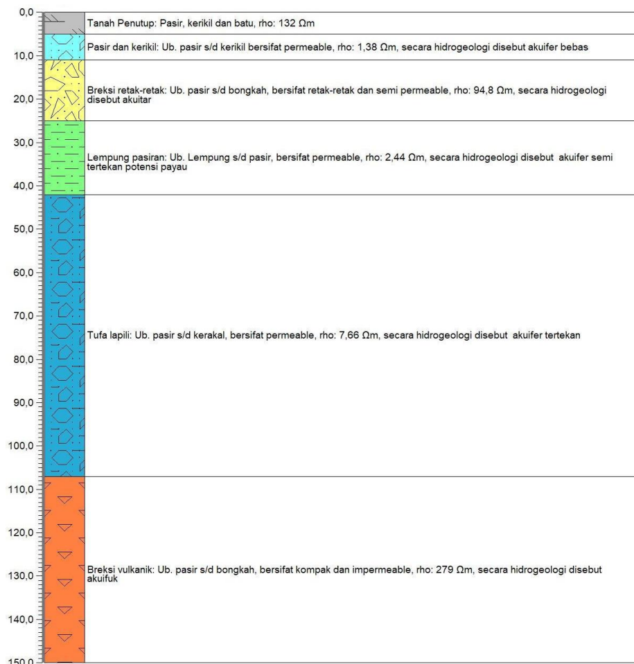
GAMBAR 4. Log Resistivitas titik sounding 3 (VES 3).
