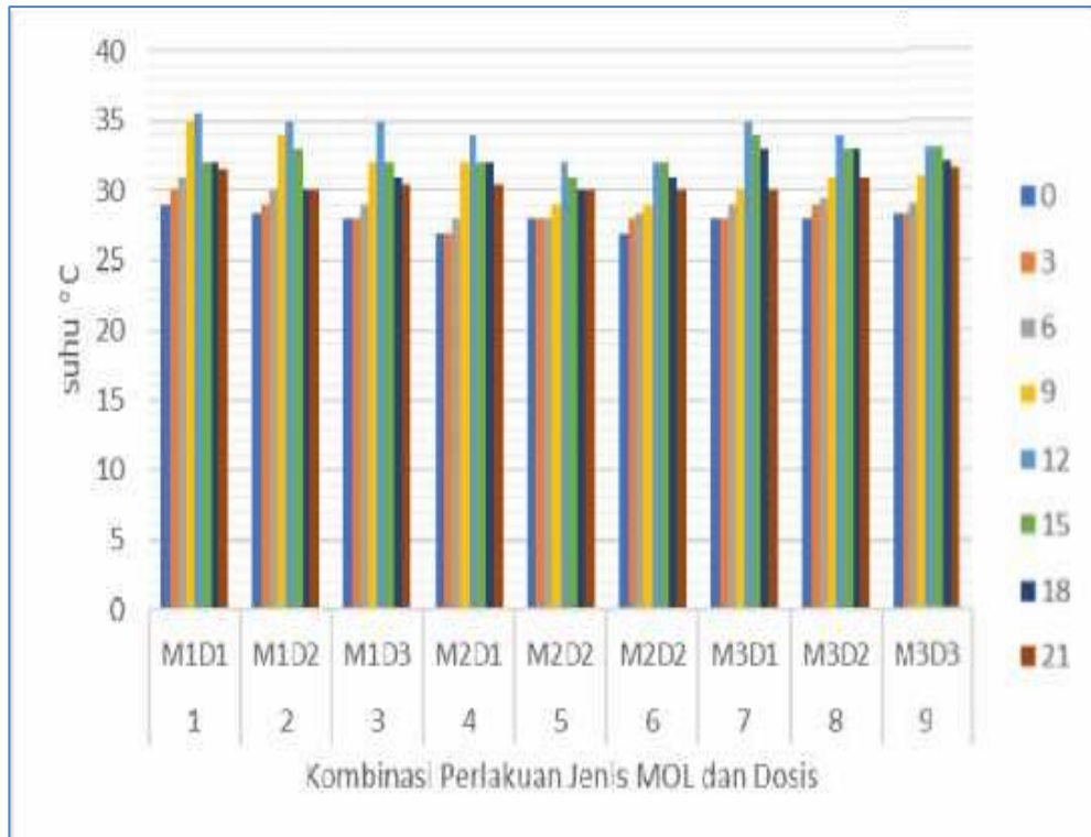
Gambar 2. Grafik Perubahan Suhu Selama Pengkomposan
